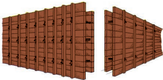
Armatura con morsetti
